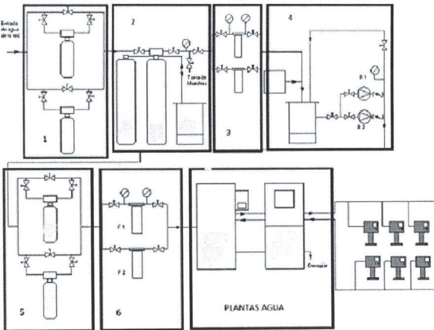
83. No esquema que se achega, do pretratamento de auga para diálise, indicar en cal das fases que se indican, se elimina a dureza da auga.
